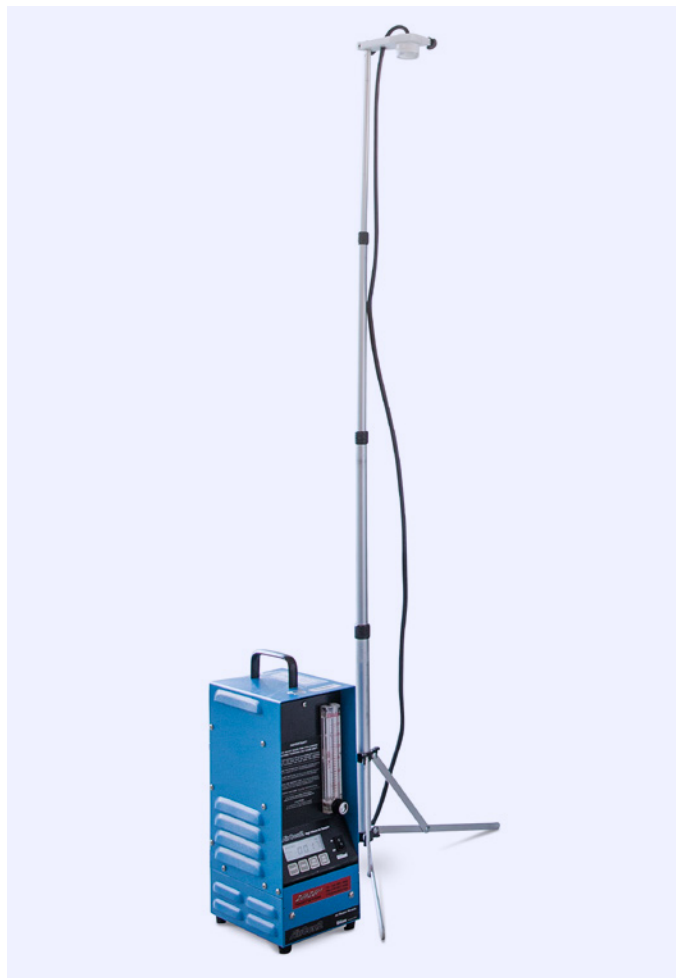
持ち運び型中容量ポンプ ポイントモニタリングに使用
