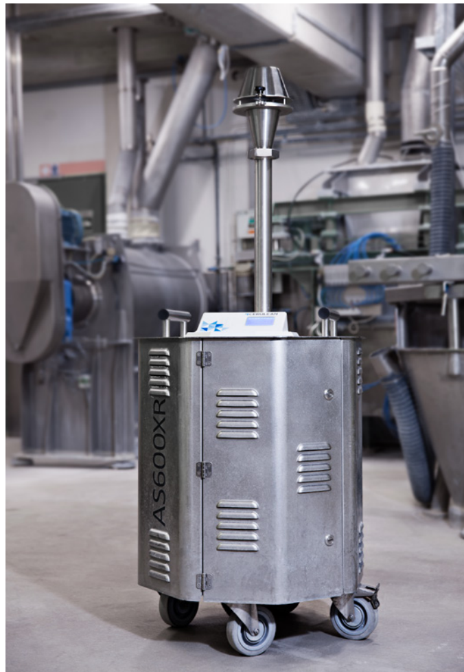
据置型高容量ポンプ ばく露面積の測定に使用
